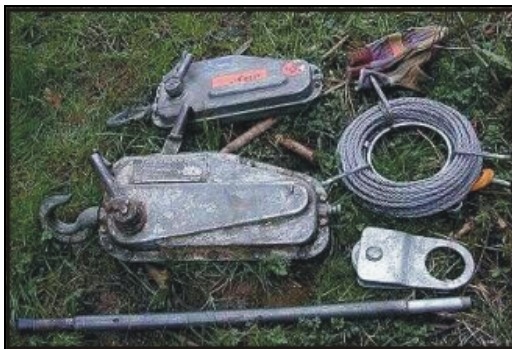
Figura 6.4.2-7 - Equipamento Tirfor e seus acessórios
