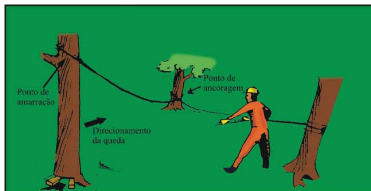
Figura 6.4.2-8 - Ilustração da técnica de ancoragem, onde podem ser combinadas as utilizações de cunha, de tirfor e de assimetria na largura da dobradiça
