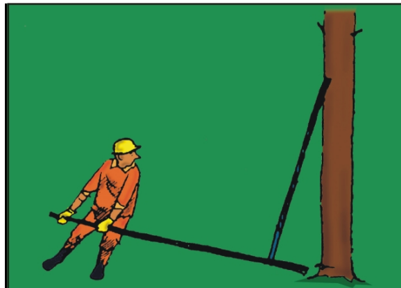
Figura 6.4.2-9 - Técnica de apoio para redirecionamento da queda da árvore utilizada para árvores de pequenas dimensões
