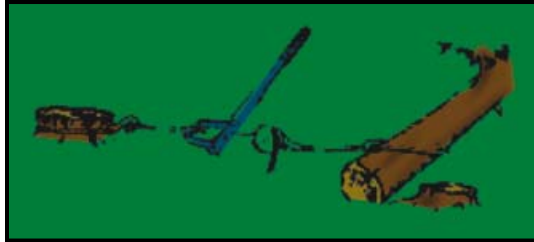
Figura 6.4.2-6 - Redirecionamento da queda da árvore através da adoção de cunha e assimetria na largura da dobradiça/utilização do tirfor no redirecionamento da queda da árvore.
